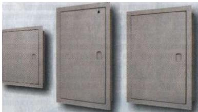
Дверцы ниш предназначены для обеспечения доступа к каналам скрытых коммуникаций. Покрытие порошковое полимерное. Цвет покрытия КАБ 9016 (белый) и КАБ 7032 (серо-бежевый). Степень защиты IP31 по ГОСТ 15543.1-89. Климатическое исполнение и категория размещения УХЛ4 по ГОСТ 15150-69 и ГОСТ 15 543.1 - 89.
